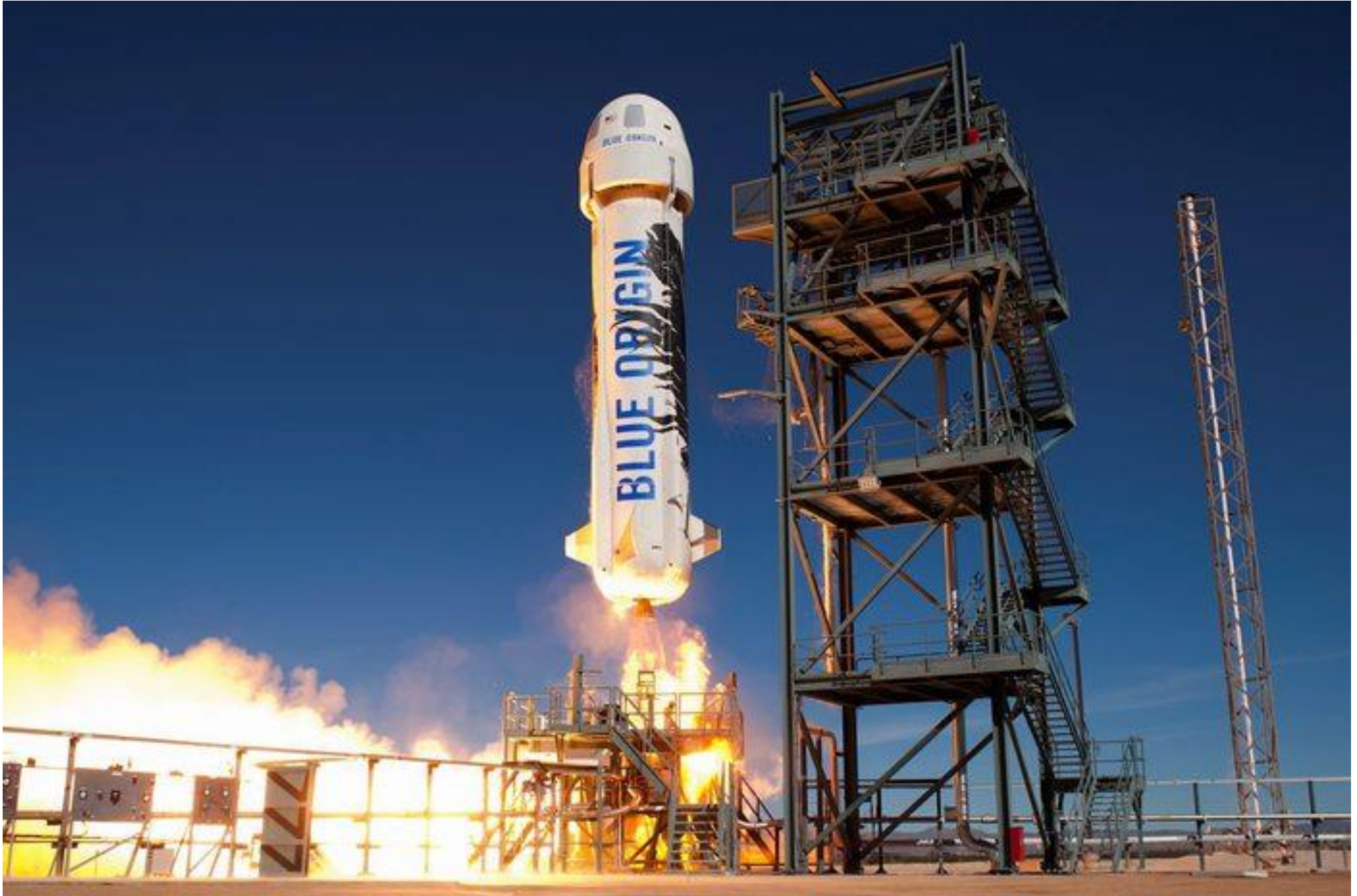
New Shepard moteur-fusée BE-3 de 50 t de poussée O 2 et H 2 liquides
