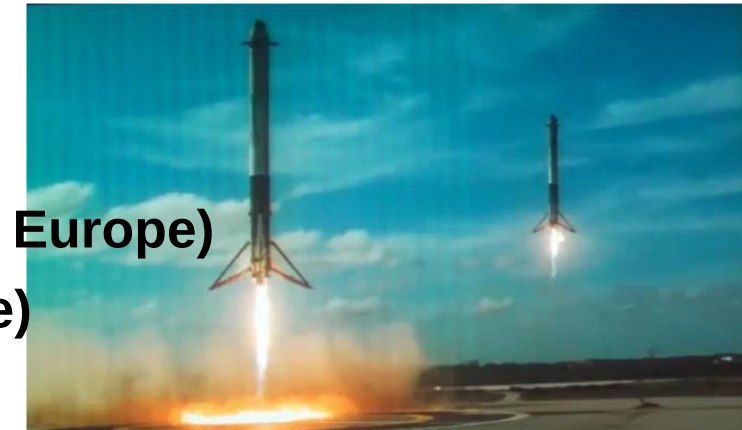
Récupération simultanée de 2 étages (propuls. secondaires) de Falcon Heavy ( Falcon Heavy = 3 Falcon 9 )
